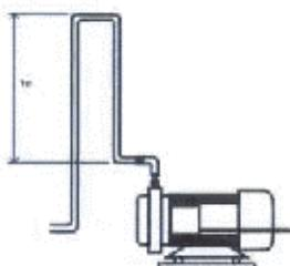
В некоторых случаях для предотвращения возможности «возврата жидкости» в направлении компрессора можно установить т.н. «защитную колонку» высотой около 1 метра.
